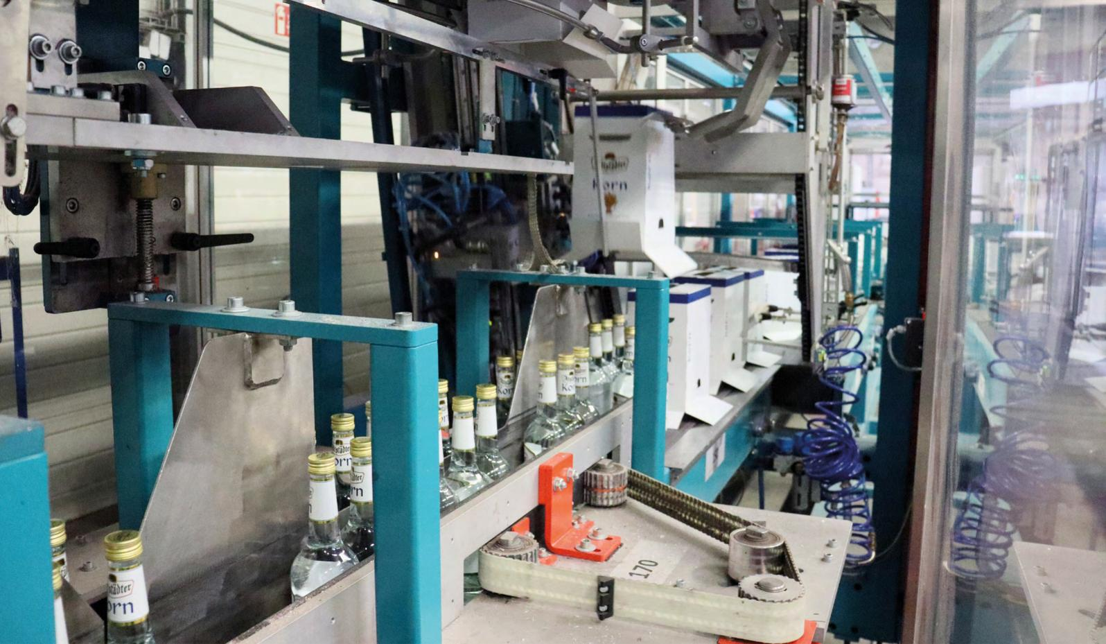
Separieren der Flaschen zu Sechsergebinden mit anschließendem Überstülpen des Kartons (Bilder: Project A&E, Kranenburg)
