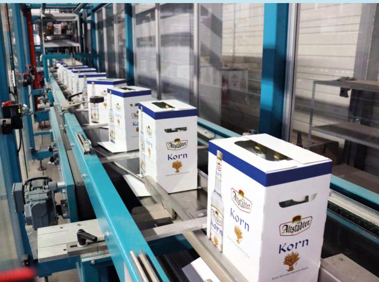
Beim Verschließen des Kartons von unten fährt dieser nun nur noch über eine Art ‚Blechstreifen‘, der schmäler ist als der Karton, sodass die Lasche darunter gefaltet werden kann.
